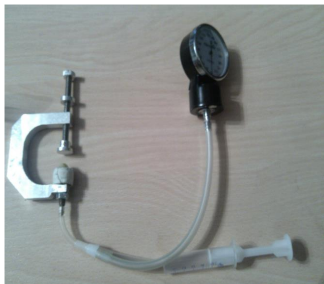
Рисунок 2 – Ранняя версия эдемометра
