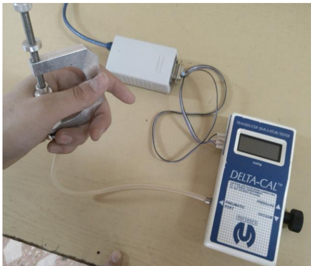
Рисунок 3 – Автоматизированная версия эдемометра
