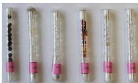
*Рис. 4 – Гранулы силикагеля после пропускания  $H_2S$*
