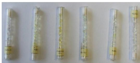
*Рис. 2 – Трубки с силикагелем после пропускания  $\text{Cl}_2$*
