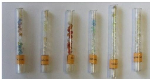
*Рис. 3 – Окраска гранул силикагеля после пропускания  $NO_2$*
